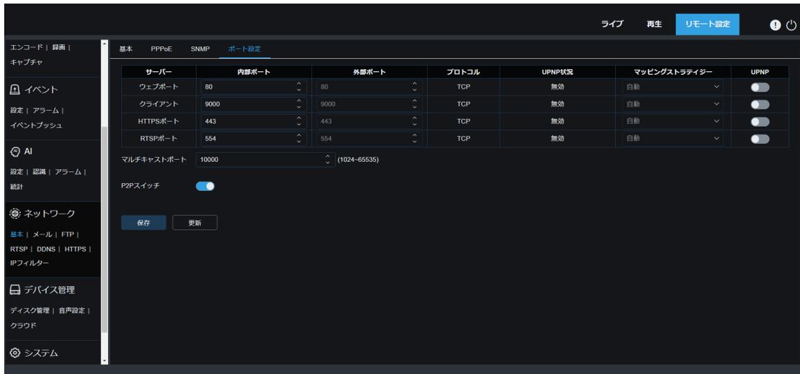
**ウェブポート:** これは、IPCにリモートでログインするために使用するポートです (例えば、ウェブクライアントを使用する場合)。他のアプリケーションがすでにポート80を使用している場合は、変更してください。
