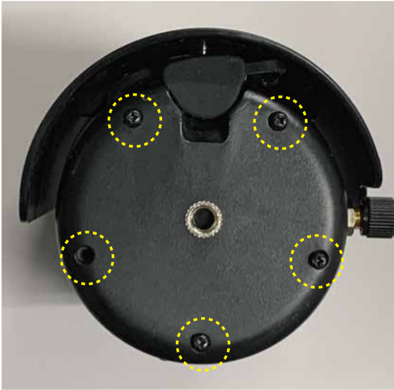
① 5箇所のビスを精密ドライバーで外します。
