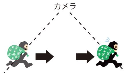
動体検知（motion detection）とは、指定エリア内で物体の動きや色合いの変化等を検知するセンサーです。
