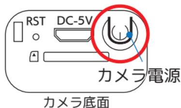
(1) カメラの電源を長押しして「オン」にしてください。カメラから「ポポーン」と音が鳴ります。
