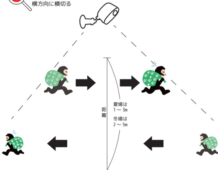
夏場は外気温と人間の体温の差が少ないため、人感（熱検知）センサーが反応しにくくなります。なるべく低い位置（2m～2.3m位）に設置し、センサーが反応する方向（左右）、角度（傾き）で設置をしてください。
