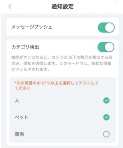
カテゴリ検出をオンにすると、ケアエリアで設定した範囲に、「人」、「ペット」、「車両」を検知した時だけ、通知がくる設定をすることができます。
