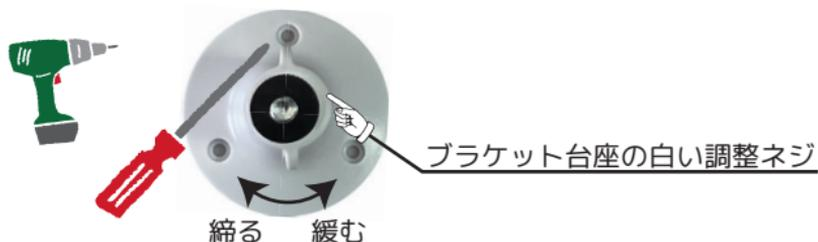
③ブラケット台座にカメラを取付け、角度を調整します。
