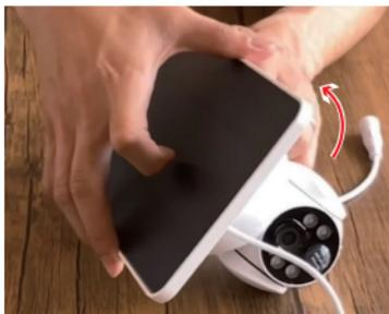
③ソーラーパネルのビスを緩めてパネルの角度を調整します。角度が決まりましたらビスを閉めます。
