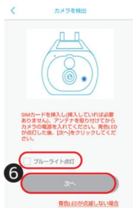
※赤⇔青の高速点滅の場合は、SIMカードを挿入してください。
