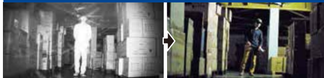
一般的な赤外線照射 (IR) カメラの暗視映像 (赤外線照射による浮遊物の散乱反射)
