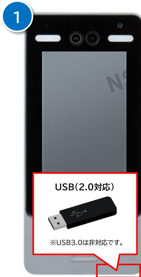
デバイス下部のUSBポートにUSBを挿入します。
