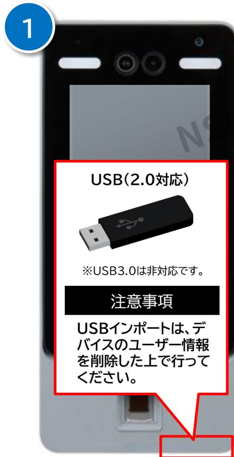
デバイス下部のUSBポートにお手持ちのUSBを挿入します。本体側に挿入口があります。
