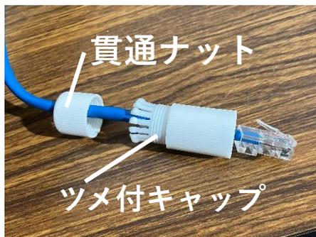
**6** ④と⑤を接続します。スリットゴムをケーブルに噛ませ、ツメ付キャップの隙間に入れます。
