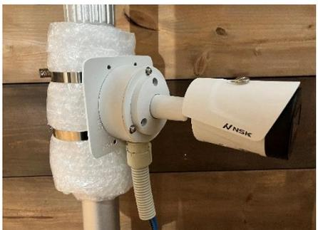
**画角調整** カメラの首部分にあるボルトをプラスドライバーでゆるめ、モニターを見ながら首を動かして画角を調整します。
