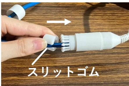
**7** 貫通ナットとツメ付キャップを接続して、絶縁処理をします。
