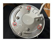
①IP-9404PTZ-AI 側 ネジを緩めプレート金 具を外します。
