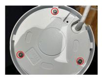
④IP-9404PTZ-AI 側 の 3 点のネジを 締めます。
