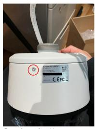
⑦固定ネジを締めてカメラ とブラケットを完全に固定 します。
