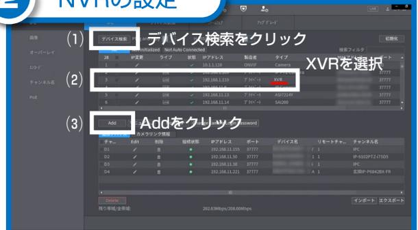
ビデオサーバーをNVRに接続し、NVRの設定をします。メインメニューの下部にあるカメラをクリックします。「デバイス検索」をクリック、XVRを選択し、「Add」をクリックします。
