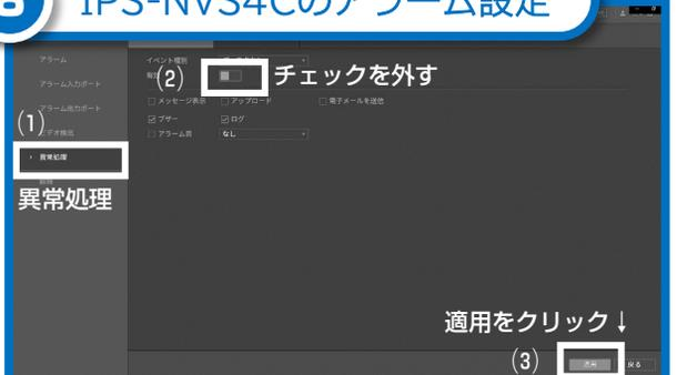
メインメニュー「アラーム」から左のタブ欄の異常処理を選択し、HDDメニューを開きます。イベント種別「ディスクなし」の有効のチェックを外し画面右下の「適用」をクリックします。
