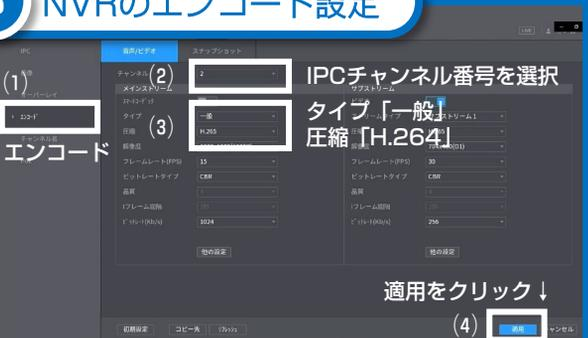
左のタブ欄のエンコードをクリックします。音声/ビデオメニューを開き、④で登録したIPCチャンネルを選択します。タイプを「一般」、圧縮を「H.264」にし、画面右下の「適用」をクリックします。
