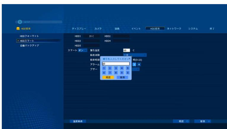
■ **ブザー**: HDDの温度が設定した温度しきい値を超えときのブザー音のON/OFFを選択してください。
