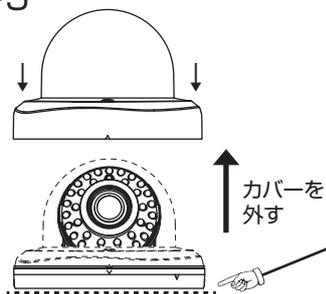
・図・5のようにカバーにある4ヶ所の固定ねじを付属のレンチで緩め、カバー部分とカメラ部分を外します。
