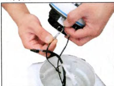
カメラソケット側のヒーター端子とドーム側のヒーターを接続します。
