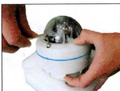
ケーブルの設定が終わったらカメラ本体とカメラカバーユニットを合体させます。
