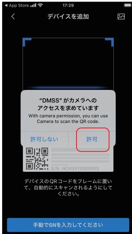
②製品のシリアルナンバーのQRコードを読み込みます。「カメラへのアクセスを ...」は、[許可] をタップします。
