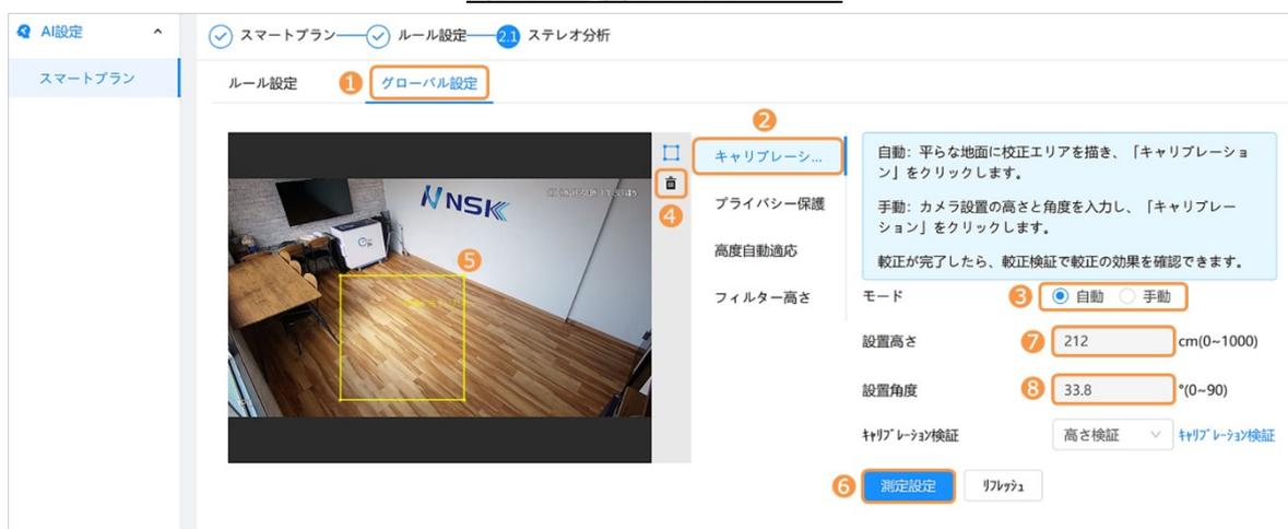
**ステップ4** ⑥[測定設定]をクリックすると、算出された⑦[設置高さ]・⑧[設置角度]が表示されます。
