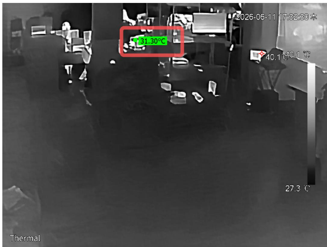
図 4-7 リアルタイムのスポット温度監視
