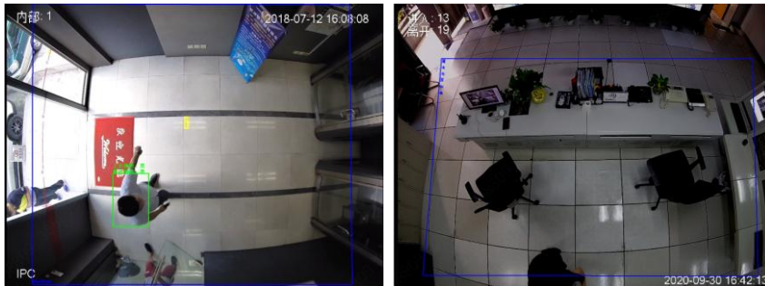
図 2-3：真下方向の監視（撮影角度：90°）の設置例
