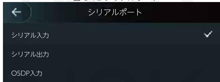
■カードの読み取りおよび書き込み機能を備えた外部デバイスがアクセスコントローラーに接続されている場合は、シリアル入力を選択します。アクセスカード情報をアクセスコントローラーと管理プラットフォームに送信できるようにするには、シリアル入力を選択します。
