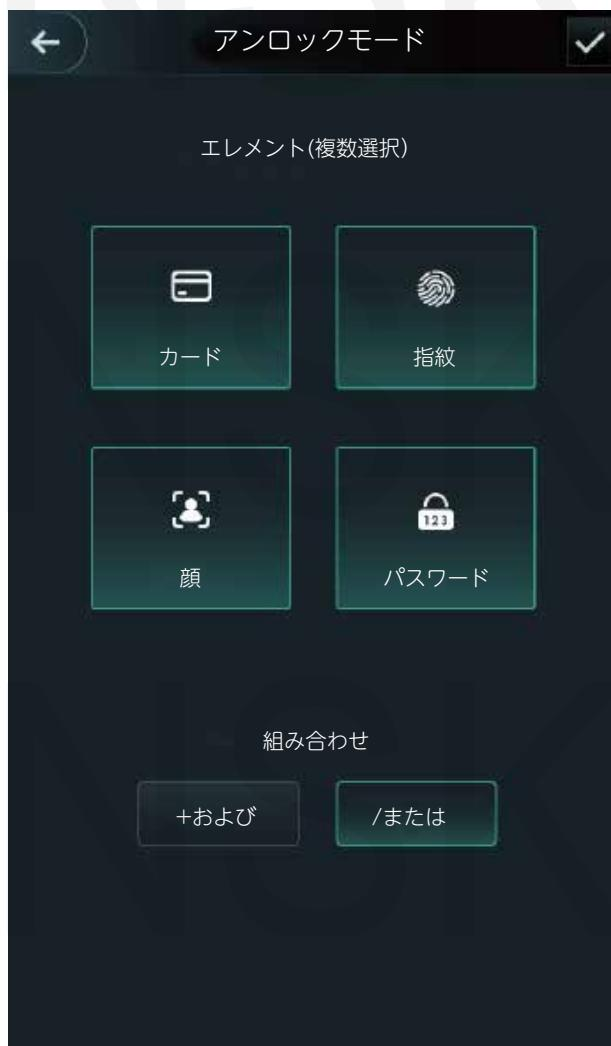
Step 2 ロック解除モードを選択します。選択したロック解除モードをもう一度タップすると、ロック解除モードがOFFになります。
