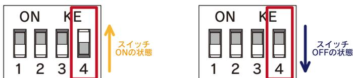
枠内の4のスイッチをONおよびOFFにすることで設定ができます。
